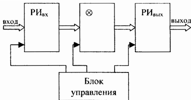
Рис. 4.1. Схема шифрователя с перестановкой разрядов: РИ_{вх} – входной регистр, РИ_{вых} – выходной регистр, \otimes – блок перестановки
